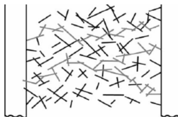
Obr. 1. Schéma sítě CNT dispergovaných v polymerní matici mezi kovovými elektrodami
